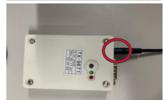
TX9671電源ケーブル
