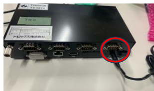
TX9674電源ケーブル
