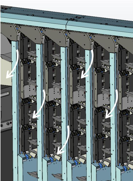
ソーター機の縦搬送路内でかんばん停止した場合も、搬送方向に滑らせるようにして移動させながら、手前側に引き抜きます。
