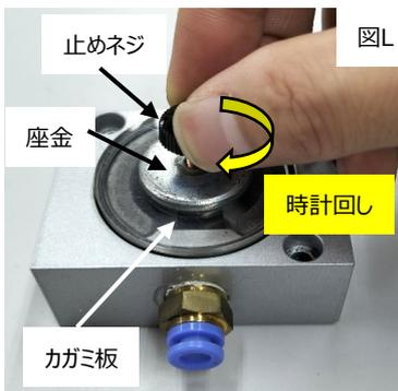
⑨ 図Lに示す通り、カガミ板・座金・トメネジを合わせ、本体に締付けて下さい。
