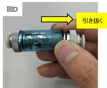
④ 図Dに示す通り、カバーをケースから引き抜きます。
